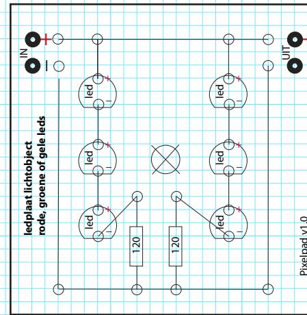
Ledplaat voor rode, groene en gele leds weerstandwaarde 120Ω bij een spanning van 9 volt, 330Ω bij een spanning van 12 volt, stroom is dan 15-20 mA.
