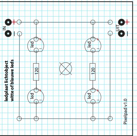
Ledplaat voor witte en blauwe leds weerstandwaarde 120Ω bij een spanning van 9 volt, 330Ω bij een spanning van 12 volt, stroom is dan 15-20 mA.
